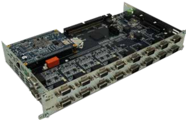
Блок управления: вычислительный модуль и плата управления
