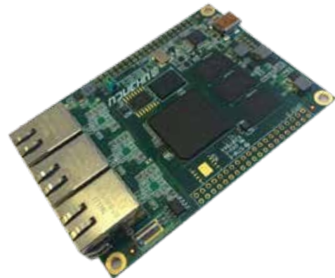
Вычислительный модуль блока управления на базе 2-х ядерного процессора и ПЛИС
