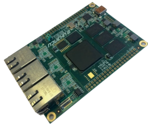
Вычислительный модуль контроллера движения на базе 2-х ядерного процессора и ПЛИС
