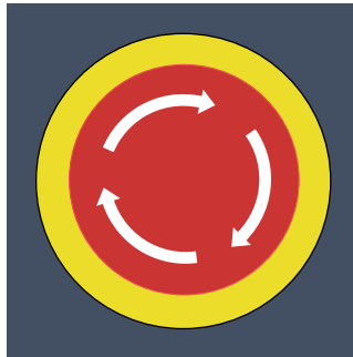
Рис. 2.10. Кнопка аварийного останова
