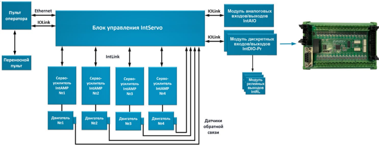
Рисунок 2 – Схема СЧПУ IntNC Pro
