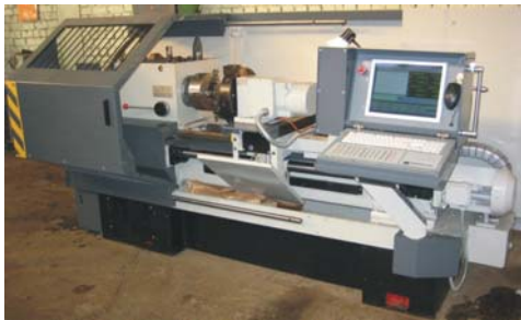
Станок 16A20Ф3 с СЧПУ IntNC-400D
