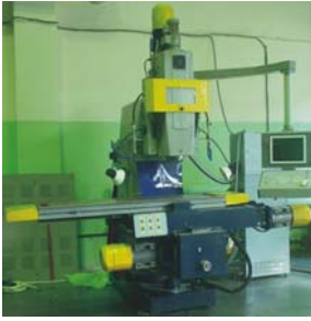
Станок 6P13Ф3 с СЧПУ IntNC-400D
